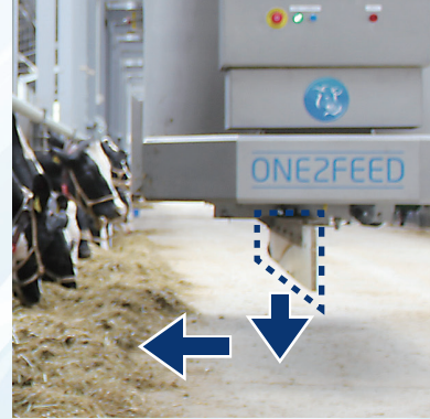
※給餌機の下から餌寄せするボードが降り、1時間に1回(変更可)、餌寄せしています。
