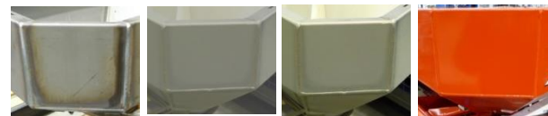
サンドブラスト→リン酸塩コーティング→粉体塗装→焼付け
