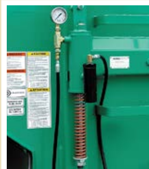
ディスクブレーキシステムの マスターシリンダーと圧力 レギュレーター
