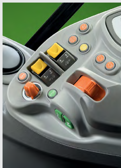
↑ 右側コンソールパネルは機能別に色識別されており短期間で操作を習得可能
