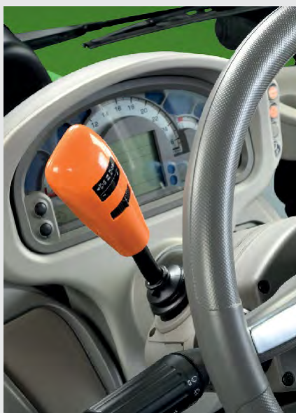
↑ 5段階にレスポンス調が整可能なパワーシャトル
