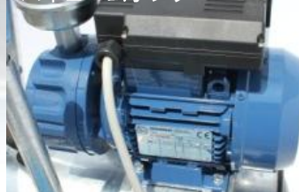
バキュームポンプ
