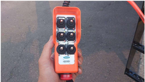
電磁弁コントローラー
