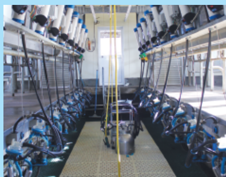
ミルクライン パーラー設備一式 ミルプロ RED・ミルクメーター 搾乳・真空圧発生・洗浄システム
